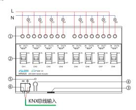
①说明:继电器输出接线端子:采用一进一出方式,孔径可接φ4电线;
